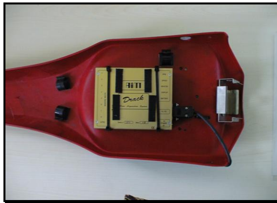
Im Frontschild montierte MDE-Box
