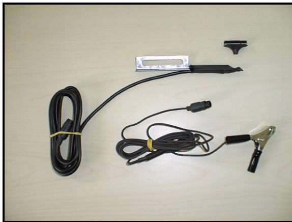
Geschwindigkeits- und Drehzahlsensor für Kart
