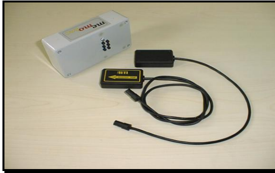
IR-Transmitter, IR-Empfänger, Magnetstreifenempfänger
